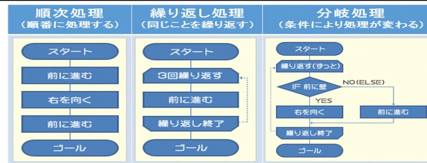
プログラムの3つの基本的な処理を流れ図(フローチャート)で表すと左図のようになります
